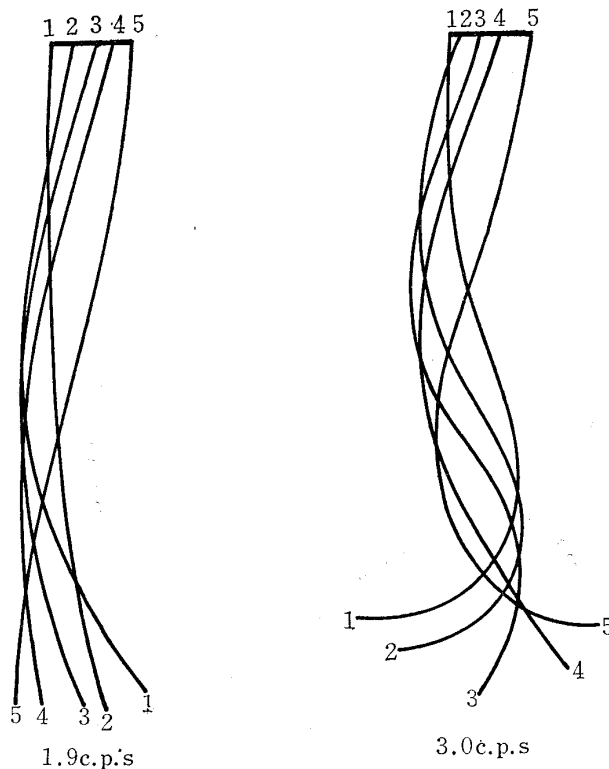
第5図 ベンベルグサテンの振動挙動 (試長 300 mm)
